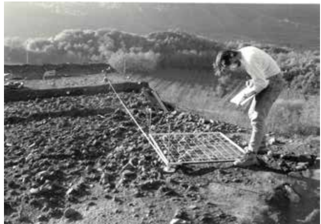
Fig. 2. Rilievo manuale con il quadrettatore (1990, archivio fotografico Cora - Trento).
